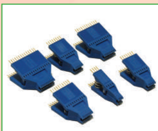
Clipes para teste de circuitos integrados SMD-SOIC 08, 14, 16, 20, 24 e 28 pinos.
